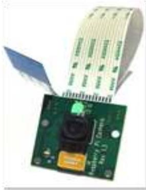
Fig. 1 : Pi-Camera module
